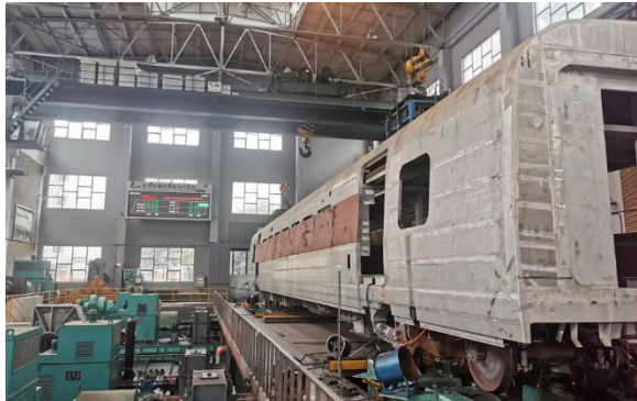
Fig. 7 Test on roller rig
